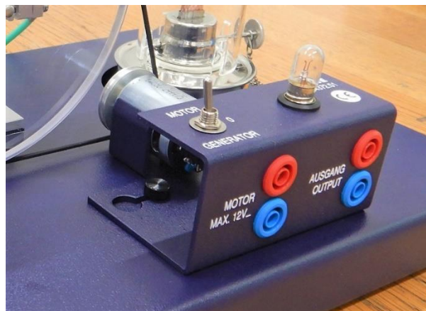
モータ発電機ユニット取付け写真
