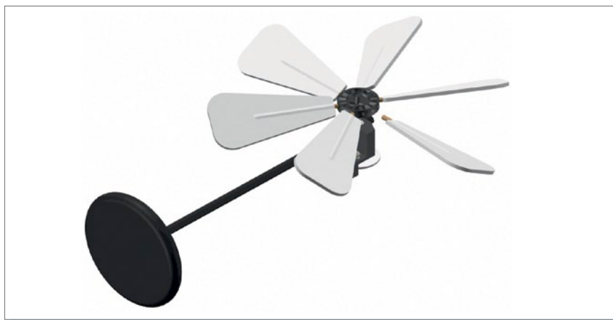
図 1: 羽根をハブに差し込みます
