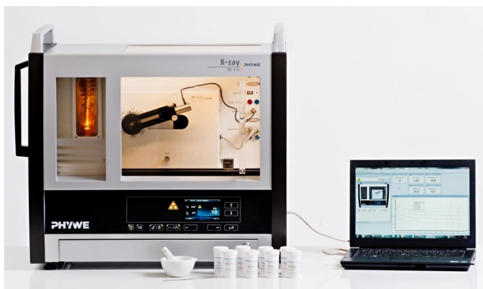
タングステン(W)X線管とゴニオメータ、GM計測管、LiF結晶設置写真 ※PCは含まれておりません
