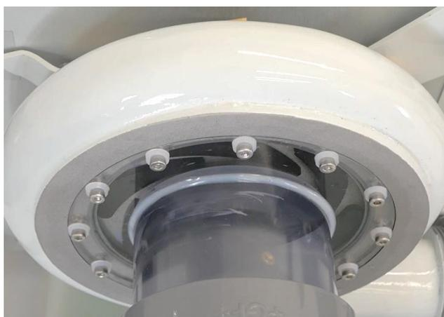
プロペラタービン取付け部（排水口）参考写真
