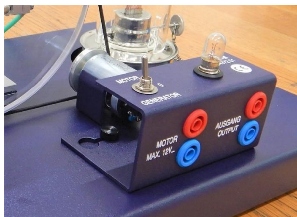
モータ発電機ユニット取付け写真
