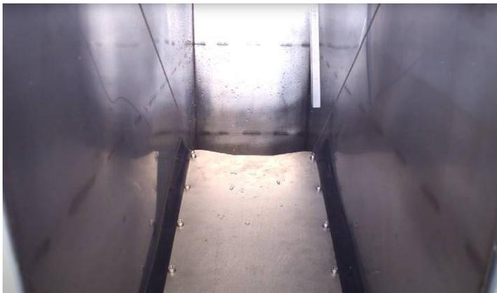
エンドゲート (電動式) 水路水位を変更します
