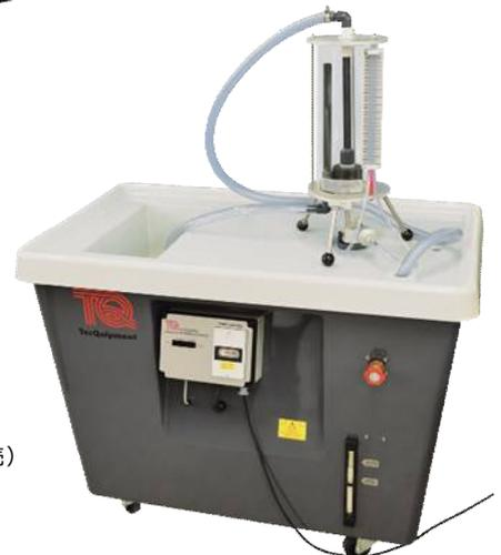
**H8 ジェット流衝突実験装置** Impact of a Jet
