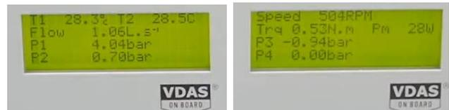
回転速度 (rpm)、トルク (N.m)、出力 (W)
