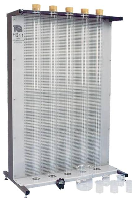
**H312 浸透水の可視化実験装置 Permeability Tank**
