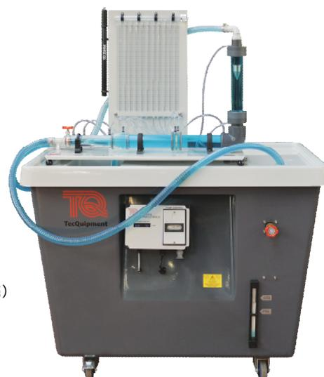
**H7 管摩擦損失実験装置** Friction Loss in a Pipe
