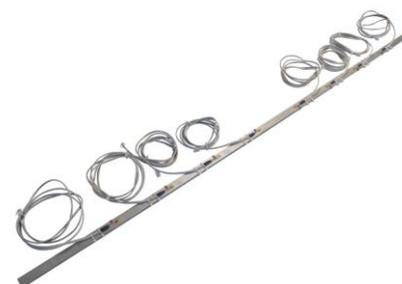
SM1004C ひずみゲージ付き試験片
